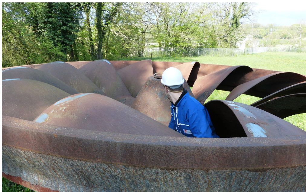
Vestige du passé, une des roues Francis de la centrale démontées en 2014 a été conservée pour servir de « témoin » aux experts.
